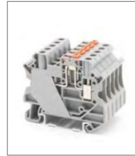
RUT 4-MT Клемма с ножевым размыкат. Ширина 6.2мм / 20A / 10мм 2 Стр. 038
