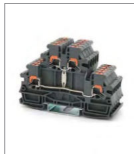
RPITT 2,5-PV Клемма Push-in, 2 уровня Ширина 5.2мм / 24А / 2.5мм 2 Стр. 006
