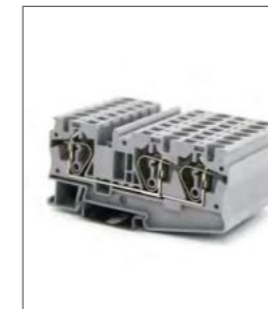
RNS 6-TWIN Клемма пружинная, 3 контакта Ширина 8.2мм / 41А / 6мм 2 Стр. 105
