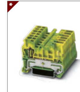
RNS 2,5/1P-PE Клемма пружинная/штекерное соединение заземл. Ширина 5.2мм / 24А / 2.5мм 2 Стр. 120
