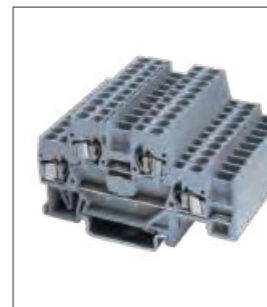
RSTTB 2,5 Клемма пружинная, 2 уровня Ширина 5мм / 26А / 2.5мм 2 Стр. 131
