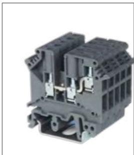
RTB 4 -TWIN Клемма проходная винтовая, 3 контакта Ширина 6.2мм / 32А / 4мм 2 Стр. 098
