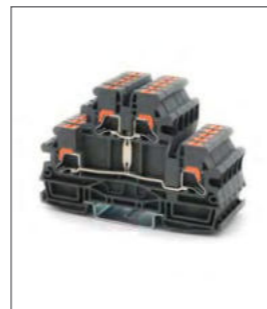
RPITT 4-PV Клемма Push-in, 2 уровня Ширина 6.2мм / 32А / 4мм 2 Стр. 006
