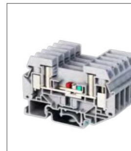
RUT 6-RTK/S Клемма с размыкат. для измерит. трансформаторов Ширина 8.2мм / 57A / 6мм 2 Стр. 040
