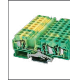
RST 2,5-TWIN-PE Клемма пружинная заземляющая, 3 контакта Ширина 5мм / - / 2.5мм 2 Стр. 136
