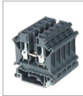
RTB 6 Клемма проходная Ширина 8.2мм / 41А / 6мм 2 Стр. 089
