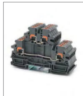
RPITT 2,5 Клемма Push-in, 2 уровня Ширина 5.2мм / 24А / 2.5мм 2 Стр. 005
