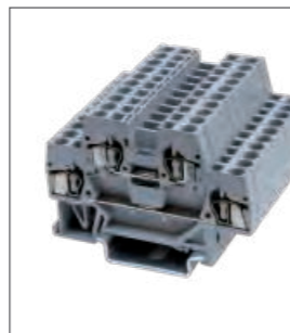
RSTT 4 Клемма пружинная, 2 уровня Ширина 6мм / 32А / 4мм 2 Стр. 131
