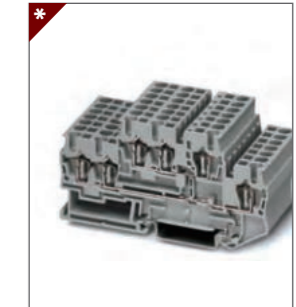
RNSTB 2,5-TWIN Клемма пружинная 2 уровня Ширина 5.2 мм / 22А / 2.5мм 2 Стр. 118
