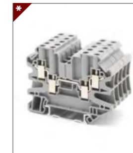
RUT 2,5-QUATTRO Клемма универсальная, 4 контакта Ширина 5.2мм / 24А / 2.5мм 2 Стр. 033
