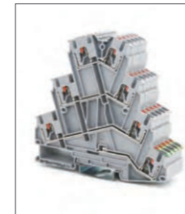
RPV 2,5-PE/3L Клемма заземляющая, 4 уровня Ширина 5.2мм / 24А / 2.5мм 2 Стр. 026
